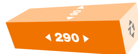
ModF Modulformat 290 x 90 x 71 mm
