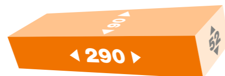
ModF Modulformat 290 x 90 x 52 mm
