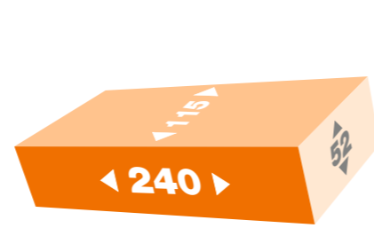
DF Dünnsformat 240 x 115 x 52 mm
