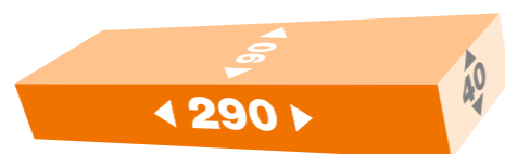
ModF Modulformat 290 x 90 x 40 mm
