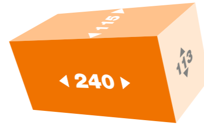
2DF Zweifaches Dünnsformat 240 x 115 x 113 mm
