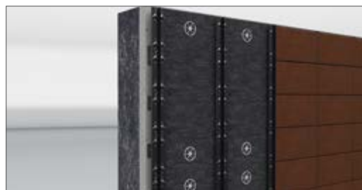
Установите тавровый профиль при помощи разрешенных крепежных средств
