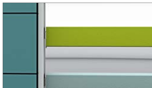
Навесьте KeraShape® при помощи вставного уголка на основание
