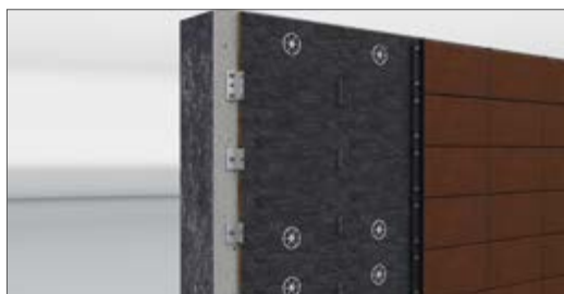
Базовая подоблицовочная конструкция
