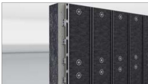
Закрепите крайние кляммеры глухими заклепками из нержавеющей стали, артикул 675-01
