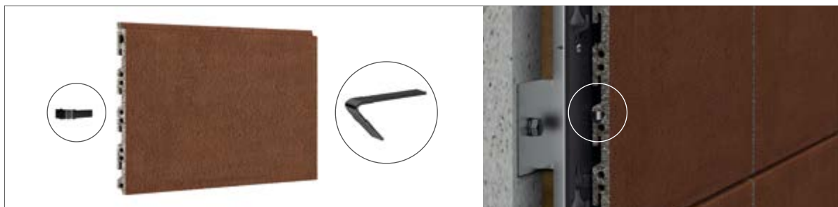
Альтернатива шовному профилю — распорка арт. 645 (для открытых швов)
