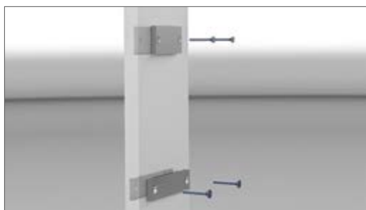
Закрепите основание на базовой подоблицовочной конструкции
